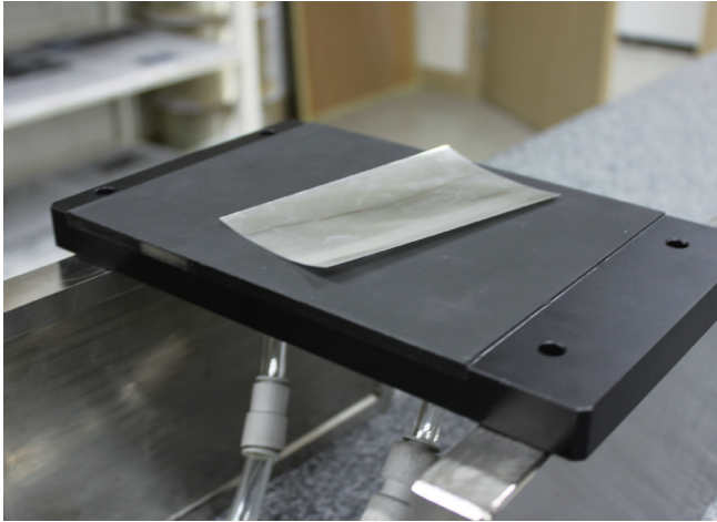
기존 에어로픽스보다 더 강력한 '에어로픽스 스트롱' 제품은 결이 심한 필름이나 굴곡, 구김 등이 심한 워크를 균일하게 흡착, 고정한다.
